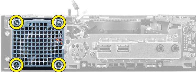
5. Déposez le ventilateur du châssis.
