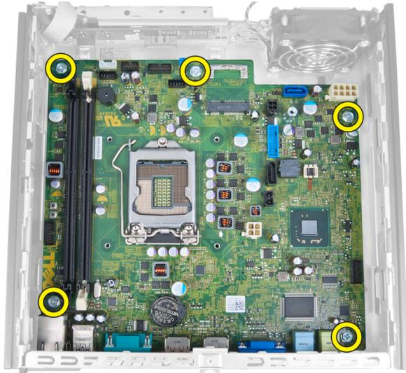
6. Déposez le vis à tête hexagonale de 7 mm de la carte système.
