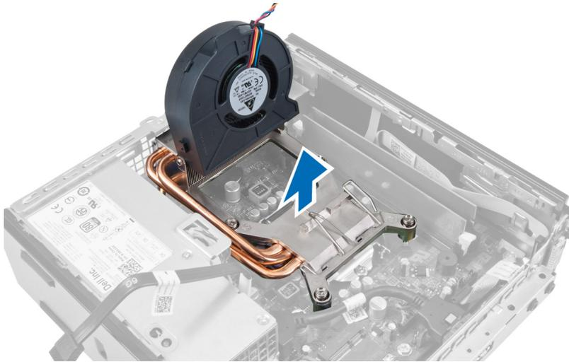
Posez l'ensemble avec le ventilateur vers le bas et la graisse thermique vers le haut.
