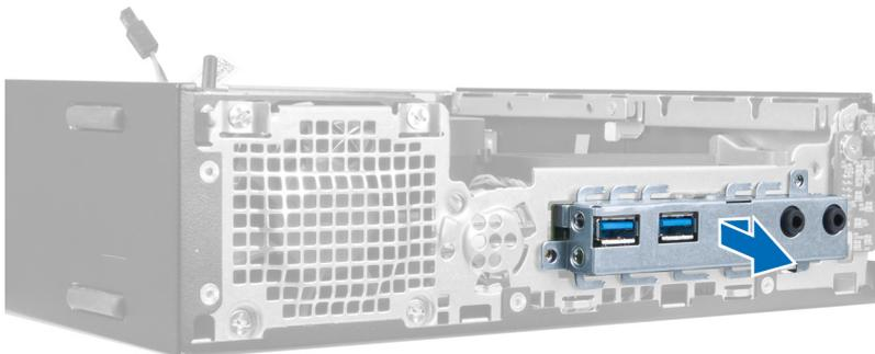
6. Déposez les vis fixant le panneau d'E/S au châssis.
