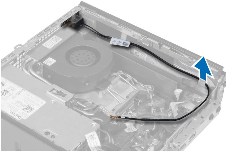
5. Déposez les vis de fixation de la pastille d'antenne sur le connecteur. Tirez sur la pastille d'antenne pour la séparer de l'ordinateur.
