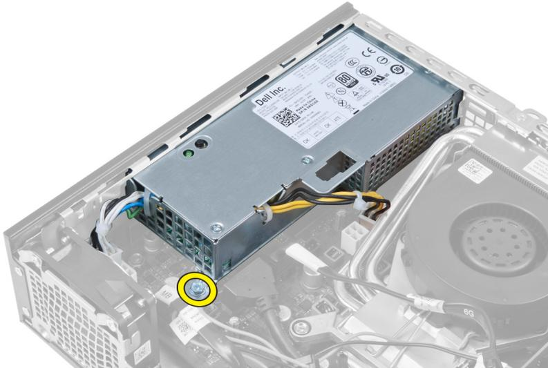
5. Déposez les vis de fixation de l'alimentation au châssis.
